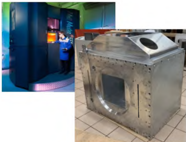
Изготовление корпусных деталей для первого в России 3D-принтера по металлу
