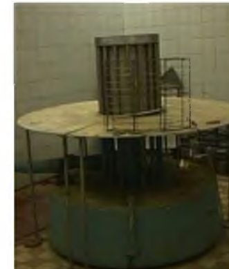
ГУ-200 (изотоп ^{60}\text{Co} , фотонов 1,3 МэВ)
